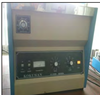
شکل ۲۷- سانتریفوژ ۵۰۰۰ دور در دقیقه برای مدت ۱۰ دقیقه
